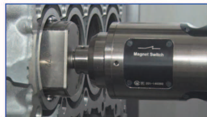
(机上自动测量加工过的孔径实例)
